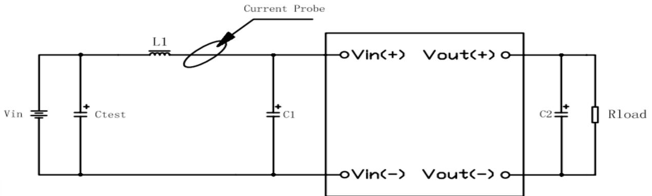
图(15) 输入反射电流测试示意图
