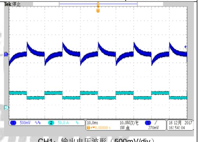
CH1: 输出电压波形 (500mV/div)
