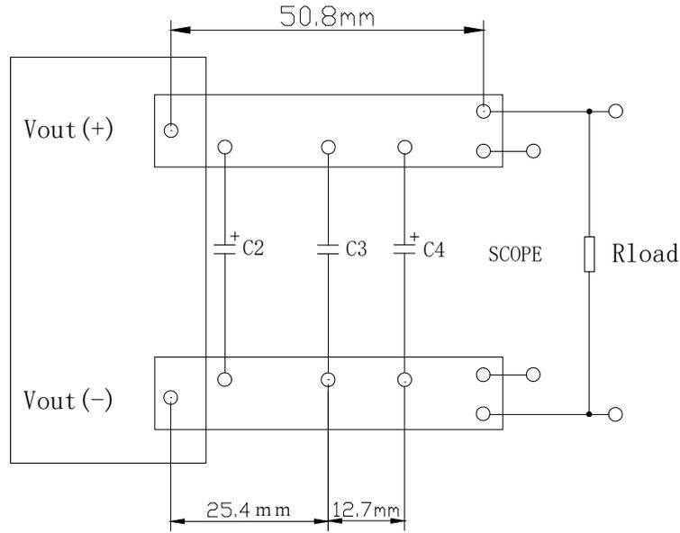
图（16）输出纹波与噪声测试示意图
