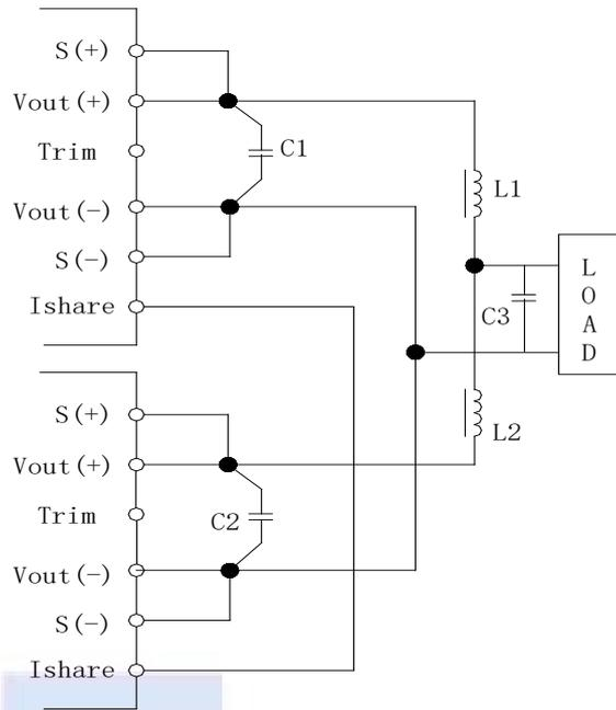
图 (20) 多路输出并联示意图
