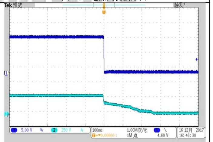
CH1: 输出电压波形 (5.0V/div)
