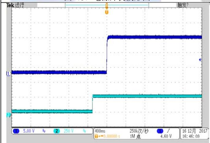
CH1: 输出电压波形 (5.0V/div)
