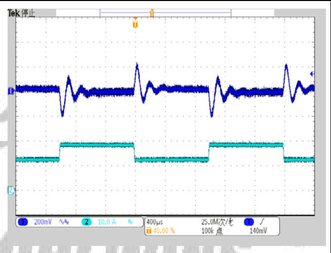
CH1: 输出电压波形 (200mV/div) CH2: 输出电流波形 (20.0A/div)
